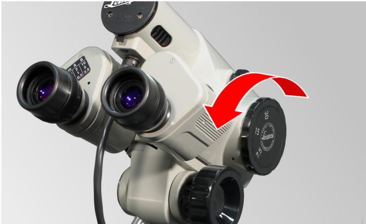
4. Gire los cuerpos de los prismas haciendo que se alejen hasta que se pueda apreciar fácilmente la misma imagen.
