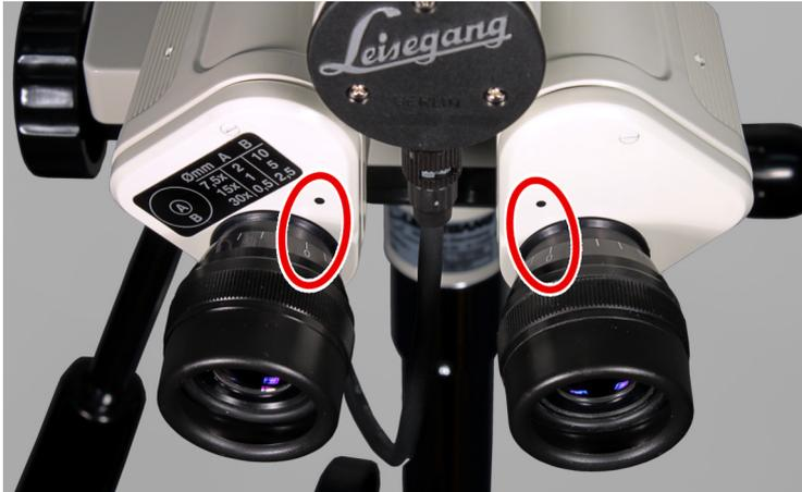
6. Mire solamente con el ojo izquierdo a través del ocular izquierdo. Los dos círculos concéntricos que se observan deben verse con nitidez. Si no fuera así, gire el anillo de ajuste de dioptrías hasta que los dos círculos se vean nítidos.
