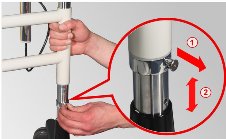
2. Vuelva a colocar con cuidado el bastidor del soporte.
