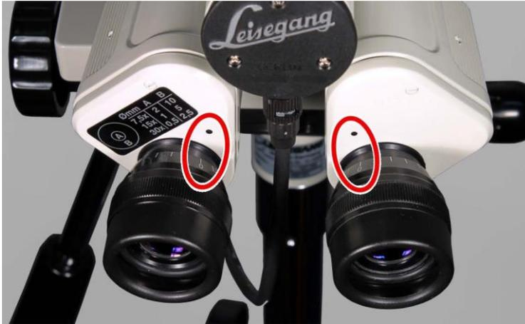
6. Guardare nell'oculare sinistro esclusivamente usando l'occhio sinistro. I due cerchi concentrici visualizzati devono essere visti in modo nitido. In caso contrario, ruotare l'anello di regolazione delle diottrie fino a quando i due cerchi non vengono visualizzati in modo nitido.
